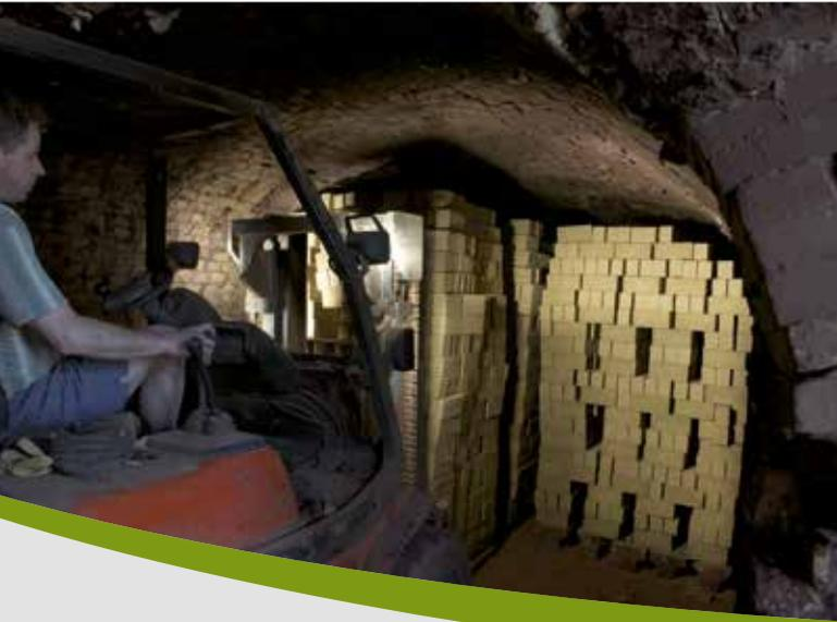
Vor mehr als 50 Jahren fing Großvater Parthoens den Bau des Ringofens an. Immer noch werden in diesem Ofen Steine gebrannt, sei es jetzt schon von der dritten Generation. Nach dem Strangenpressenverfahren wird hier ein einzigartiger Fassadenstein hergestellt. Das ist ein handwerkliches Produktionsverfahren, das noch ganz den alten Zeiten entspricht.
