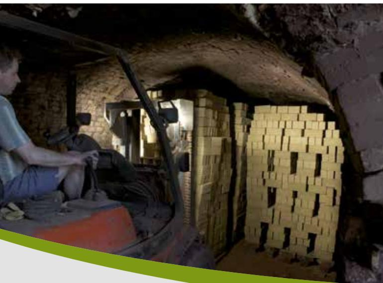
Il y a plus de 50 ans que grand-père Parthoens s'est lancé dans la construction de fours circulaires. Trois générations plus tard, ces fours sont toujours utilisés pour la cuisson des briques conformément au procédé d'extrusion. Grâce à ce procédé de fabrication artisanale, on obtient une brique de revêtement unique au charme d'antan et au caractère authentique.
